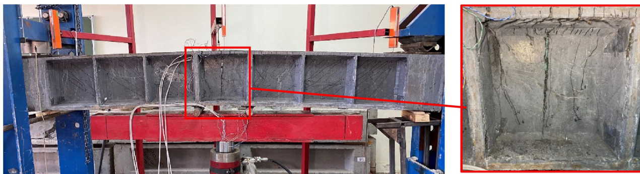
Рисунок 42 – Вид балки после разрушения
