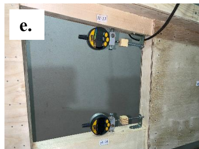
а – схема расстановки механических приборов на опытной конструкции; б, в - прогибомеры 6ПАО-ЛИСИ; г, д – электронные индикаторы с точностью 0,01 мм; е, ж – то же, с точностью 0,001 мм
