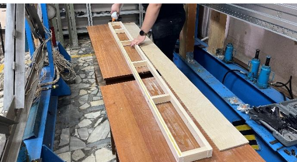
Рисунок 4.2 – Этапы изготовления опытной конструкции клеефанерного ребра
