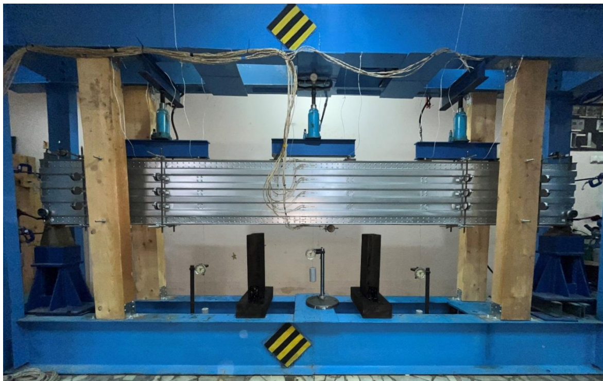
Рисунок 4.9 – Деревометаллическое ребро, подготовленное к испытаниям на силовом стенде
