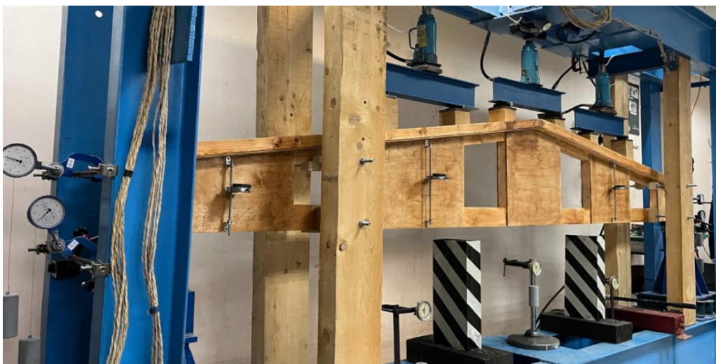
Рисунок 4.12 – Общий вид длительных испытаний клефанерного ребра на силовом стенде
