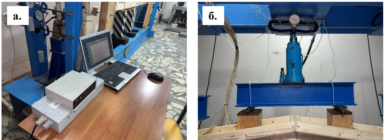
а - микропроцессорная многоканальная тензометрическая система ММТС-64.01; б – механический домкрат Q = 12,0 т и динамометр ДОС-5 на центральной траверсе
