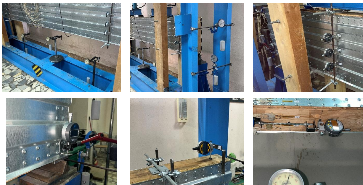
Рисунок 4.10 – Расположение механических приборов на армированном деревометаллическом ребре
