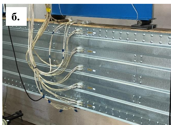
а – схема расстановки тензорезисторов на экспериментальном ребре; б – общий вид тензорезисторов, установленных на стальной профилированной стенке в середине пролета; в – тензорезисторы на деревянном поясе ребра с установкой дублирующего индикатора с ценой деления 0,001 мм на базе 200 мм
