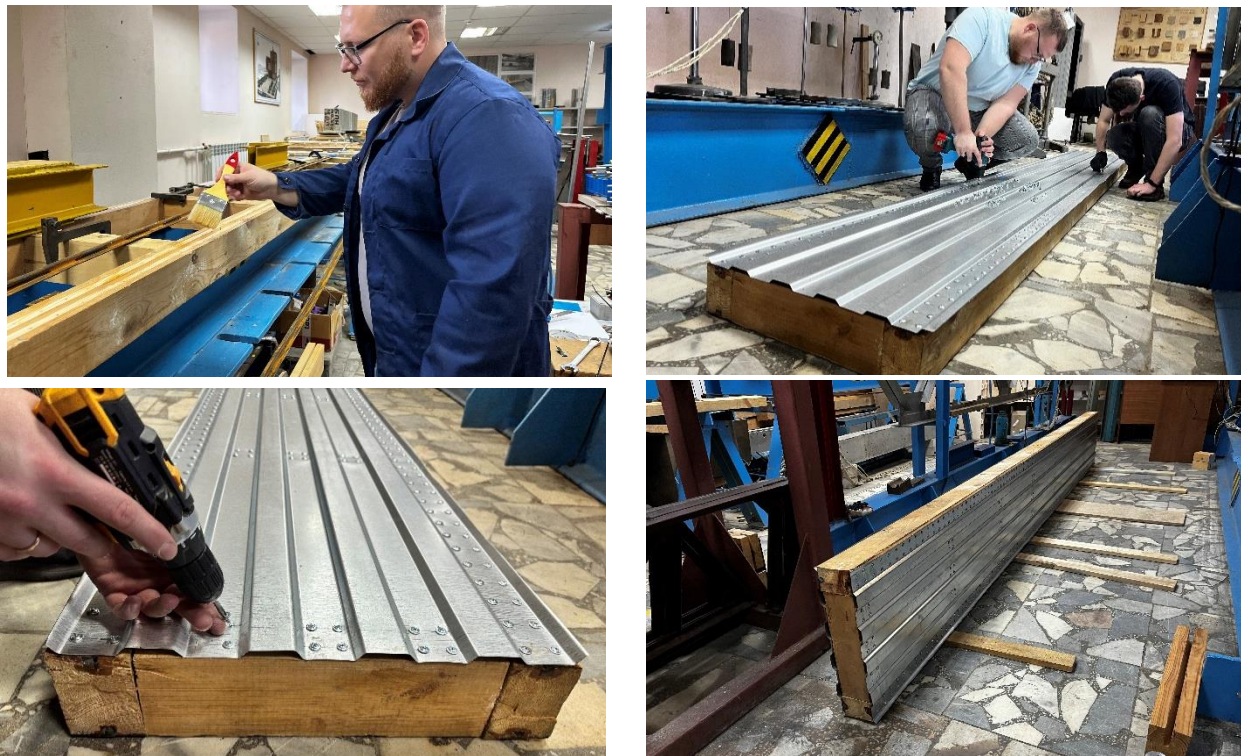
Рисунок 4.8 – Этапы изготовления конструкции армированного ребра
