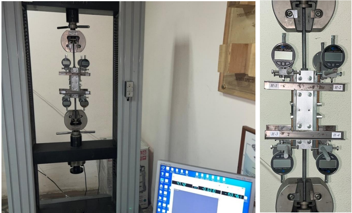
Рисунок 5.3 – Образец на растяжение, подготовленный к испытаниям для определения несущей способности соединения тонких стенок со стальными стержнями, вклеенными в массив древесины
