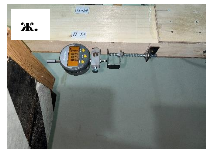
а – схема расстановки механических приборов на опытной конструкции; б, в - прогибомеры 6ПАО-ЛИСИ; г, д – электронные индикаторы с точностью 0,01 мм; е, ж – то же, с точностью 0,001 мм
