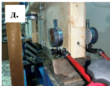
а – схема расстановки механических приборов на опытной конструкции; б, в - прогибомеры 6ПАО-ЛИСИ; г, д – электронные индикаторы с точностью 0,01 мм; е, ж – то же, с точностью 0,001 мм
