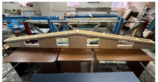
Рисунок 4.2 – Этапы изготовления опытной конструкции клеефанерного ребра
