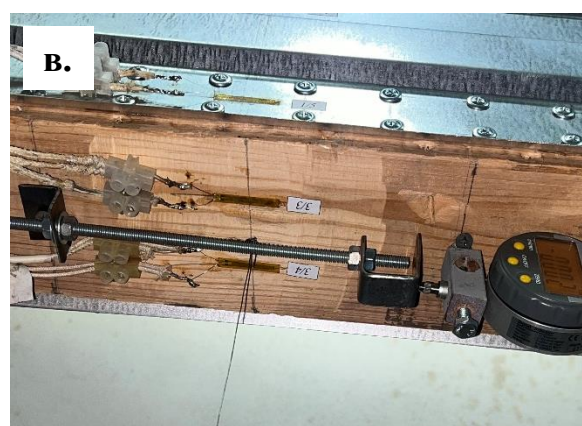
а – схема расстановки тензорезисторов на экспериментальном ребре; б – общий вид тензорезисторов, установленных на стальной профилированной стенке в середине пролета; в – тензорезисторы на деревянном поясе ребра с установкой дублирующего индикатора с ценой деления 0,001 мм на базе 200 мм
