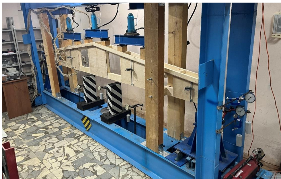
Рисунок 5 – Опытная конструкция, подготовленная к испытаниям
