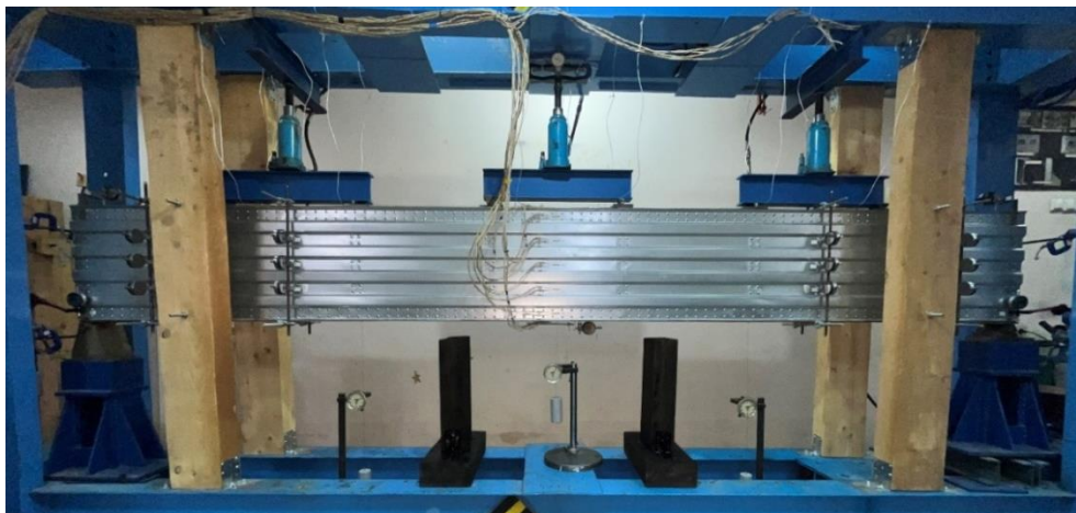
Рисунок 7 – Деревометаллическое ребро, подготовленное к испытаниям
