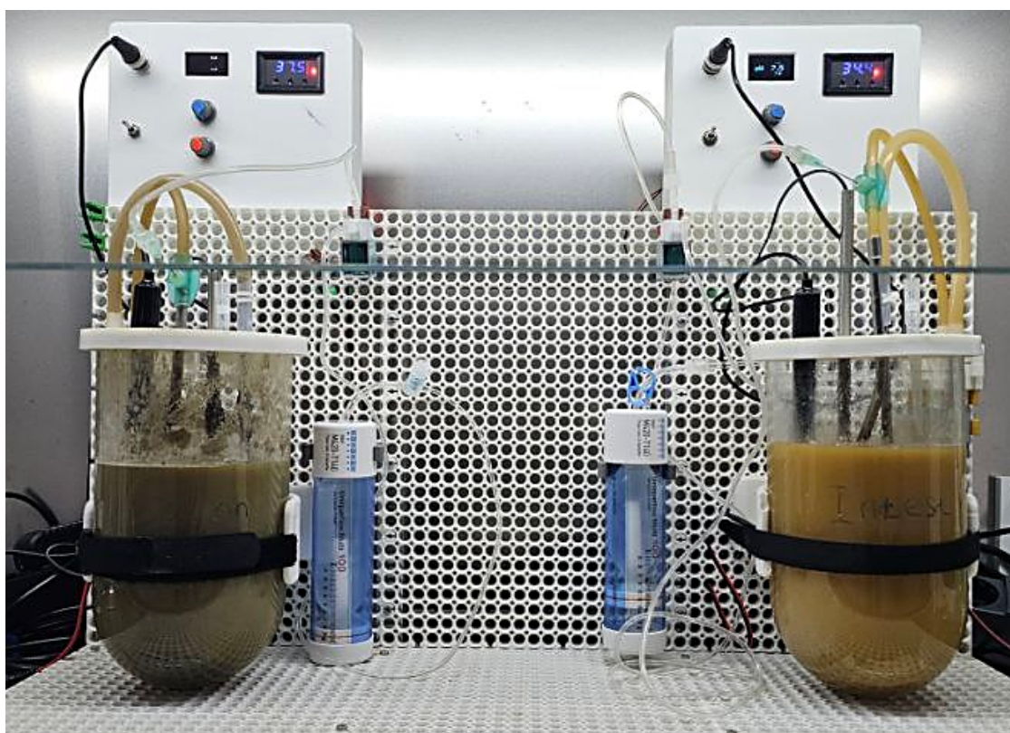
Рисунок А.1 – Установка иЖКТ, включающая тонкий и толстый отдел, заполненная кишечной средой, в ламинарном шкафу.
