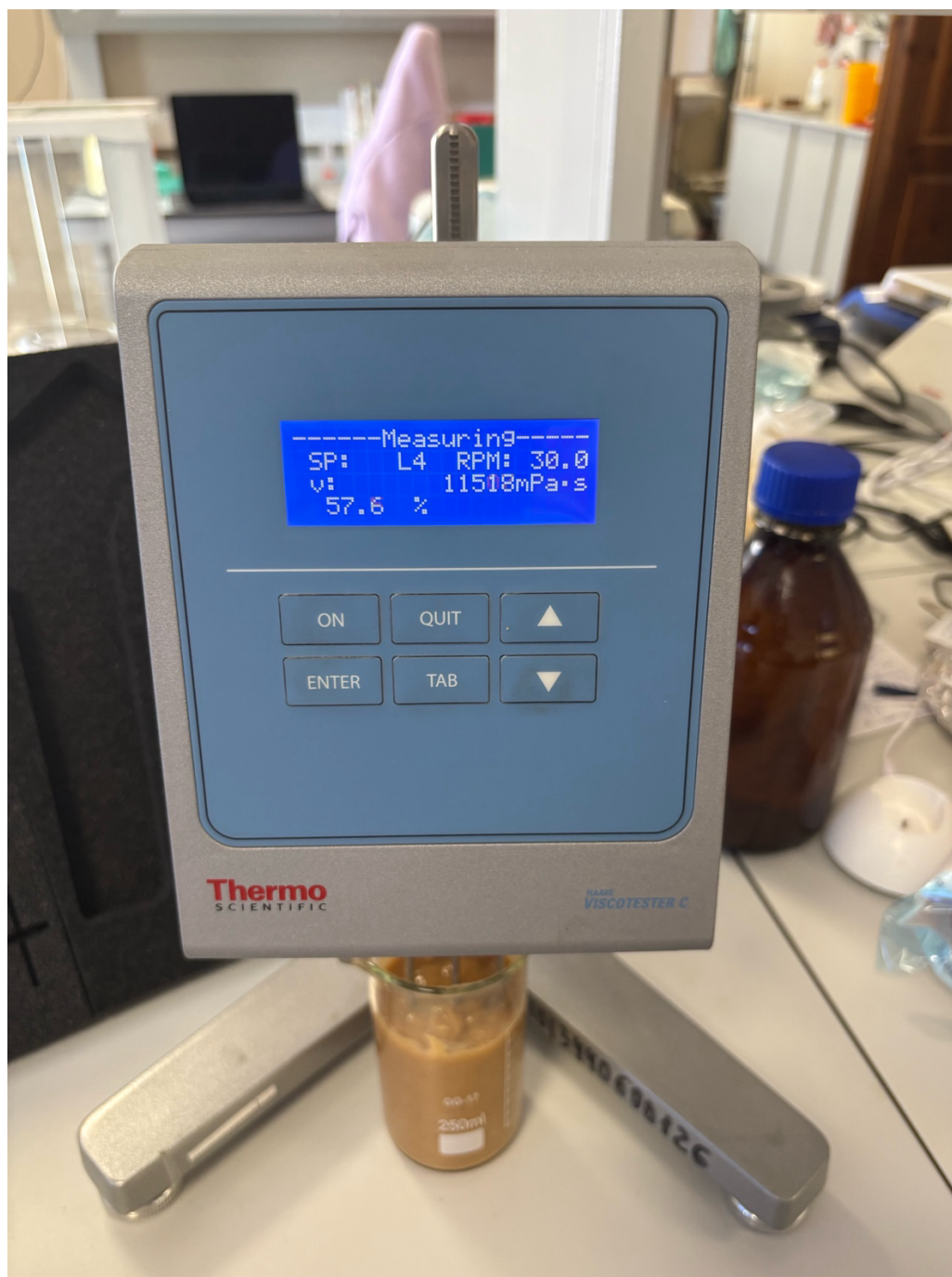
Рисунок А.3 – Измерение вязкости искусственной кишечной среды на ротационном вискозиметре Thermo Scientific HAAKE Viscotester C.
