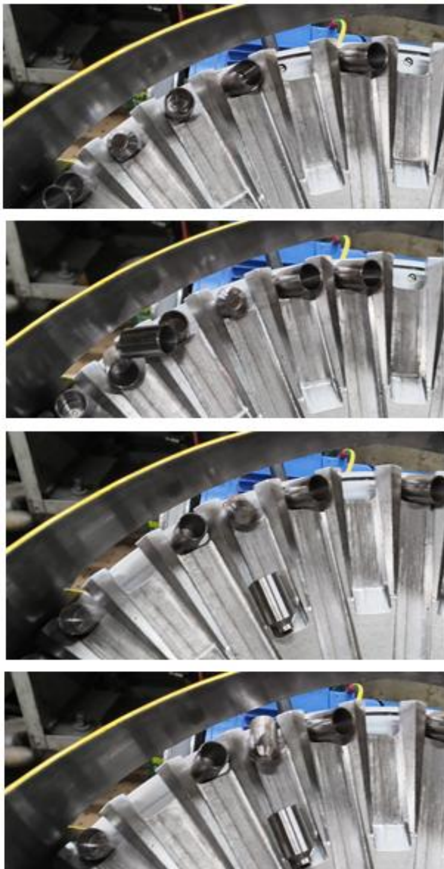
Рисунок 4.15 – Кадры процесса переориентирования заготовки тип II, h / d_2 = 1,9
