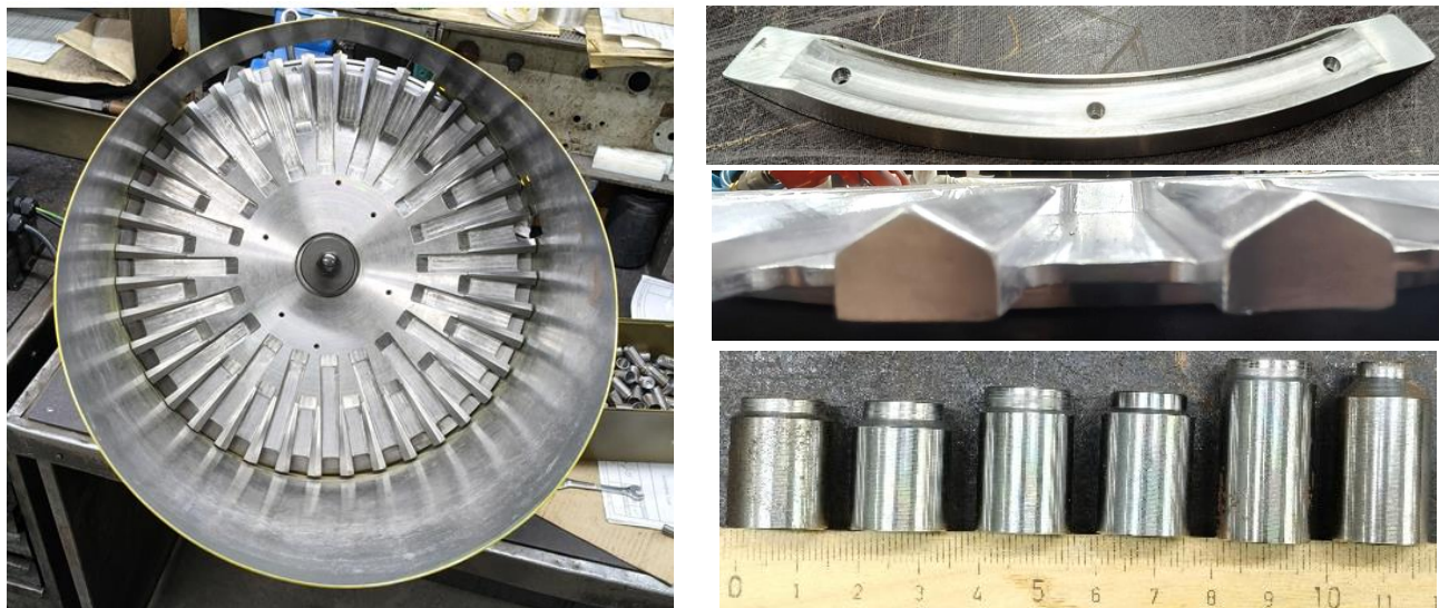
Рисунок 10 – Макет и элементы модернизированного БЗУ для шести асимметричных полых по торцам заготовок
