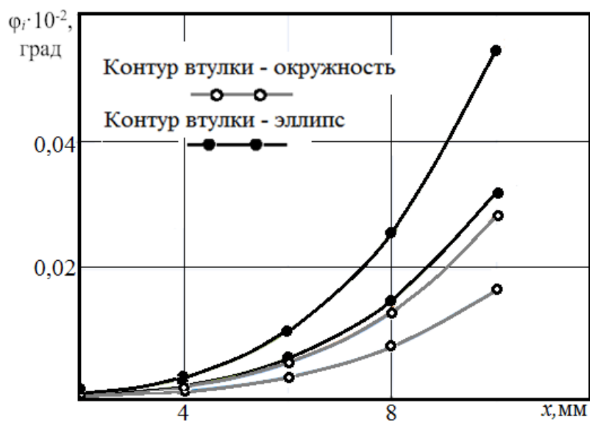
Рисунок 2.4 – Изменение угла гидродинамического клина \phi_i по длине для подшипниковых втулок с круговым и эллиптическим опорным профилем
