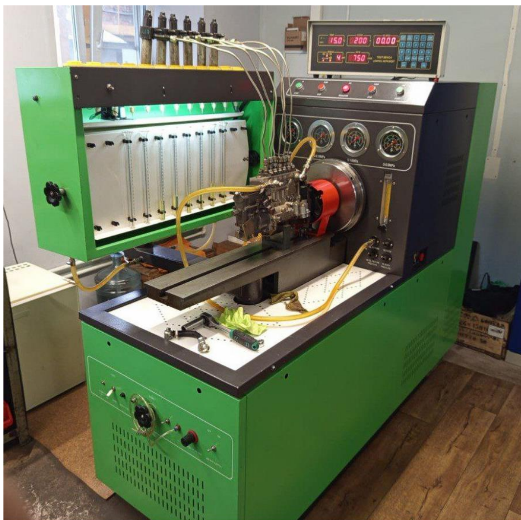
Рисунок 5.2. Стенд для проверки работоспособности насосов высокого давления с установленными подшипниками скольжения
