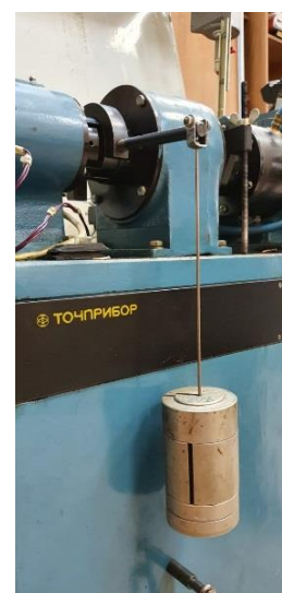
Рисунок 3.3 – Схема установки дополнительной оснастки для градуировки датчика момента трения:
