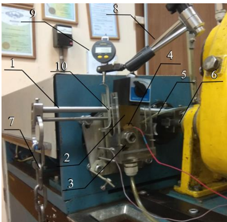
Рисунок 3.8 – Модернизированная система нагружения:
