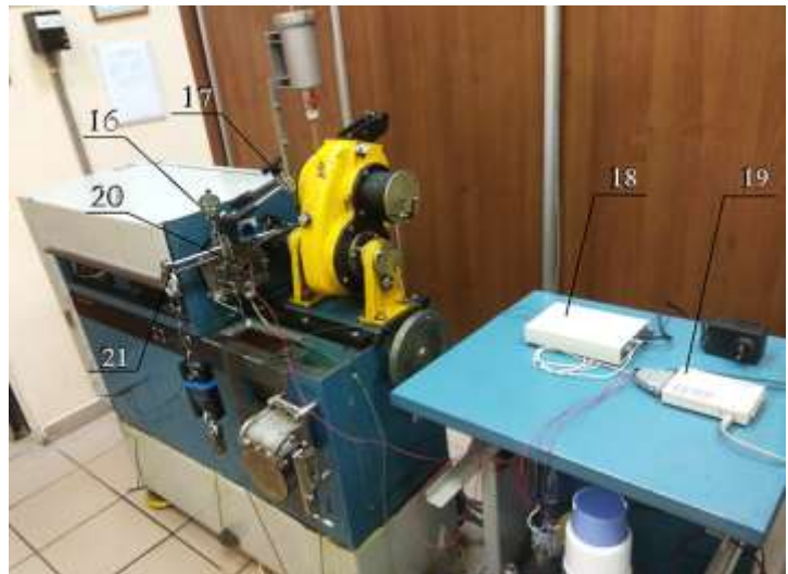
Рисунок 7 – Модернизированная машина трения ИИ-5018:
