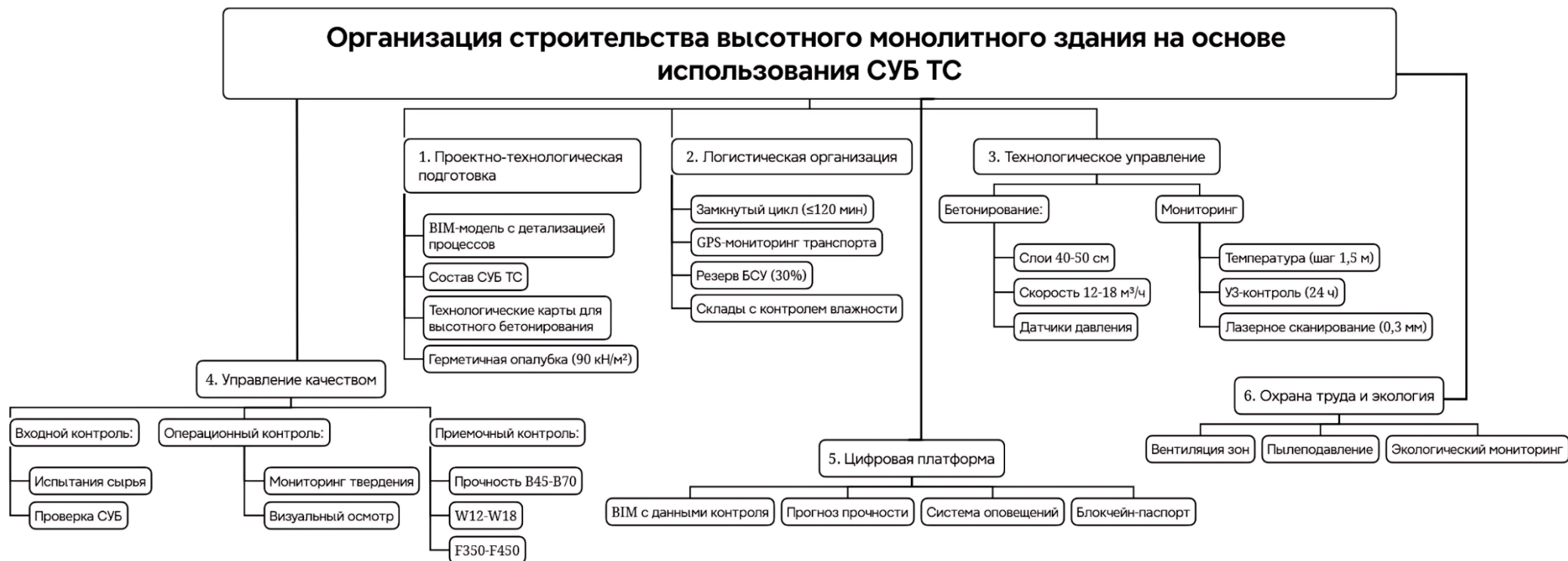
Рисунок 9. Функциональная схема организации и управления возведением высотного монолитного здания с применением СУБ
